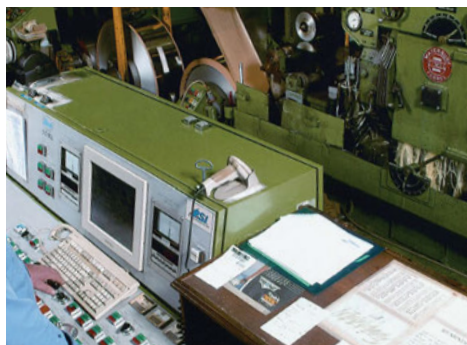
Diese Hochgeschwindigkeits-Z-Walzanlage ist ausgerüstet mit einer automatischen Abmessungskontrolle, um sofort den Arbeitsspalt anzupassen und die gewünschten Abmessungen und engen Toleranzen einzuhalten.
