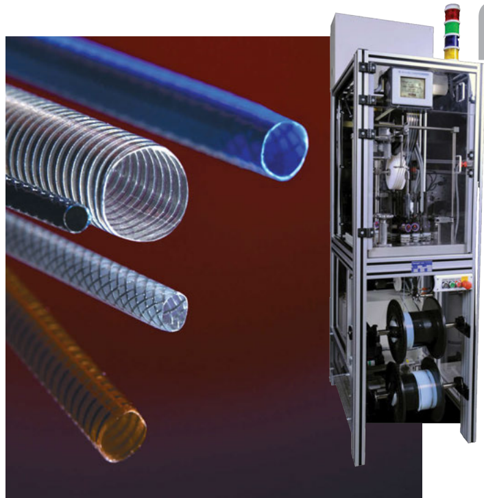
Extra-feiner Draht wird auf Spezialflechtmaschinen geflochten. Die Steeger Maschine ist oben rechts dargestellt.
